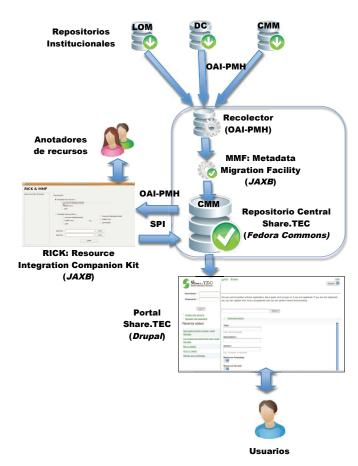
Figura 2. Arquitectura lógica del sistema Share.TEC
